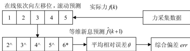
注：数字 1~5——5 维力序列，1~4 为前 4 个采样时刻的实际力值，5 为当前最新实际力 f(k) ；6*——根据 1~5 力序列所预测到的下一采样时刻的果蔬将受到的预测力 \hat{f}(k+1) ；2^, 3^, 4^, 5^——预测模型经累减还原生成的数据
