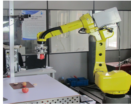
图 7 基于视觉的机器人末端执行器抓取力阻抗试验 Fig.7 Robotic end-effector impedance control based on vision
